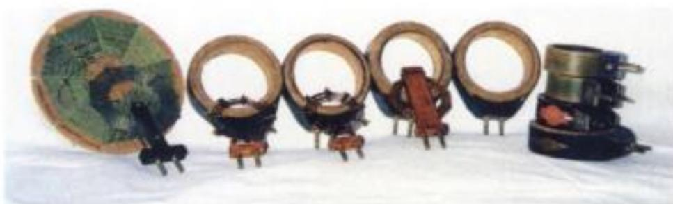
*Varios tipos de bobinas intercambiables.*
