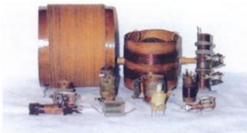
*Diversos tipos de bobinas de radiofrecuencia.*
