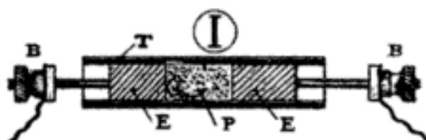
*Cohesor de Branly. B, bornes. E, electrodos. P, limaduras metálicas y T, tubo de vidrio.*
