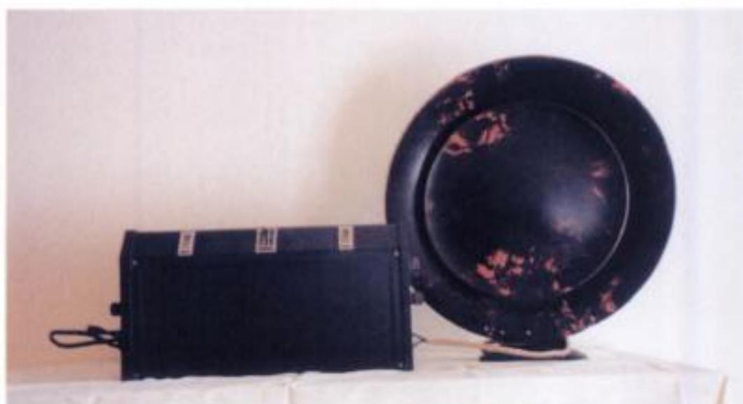
*Regenerativo de cuatro lámparas, modelo 2514. Primer receptor fabricado por Philips. 1929.*
