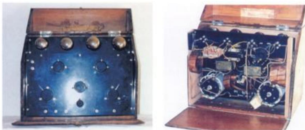
*Vista exterior e interior de un regenerativo Ducretet, de cuatro lámparas, a baterías. Año 1923-24.*
