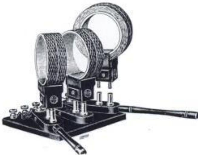
*Sistema de bobinas de acoplamiento variable.*
