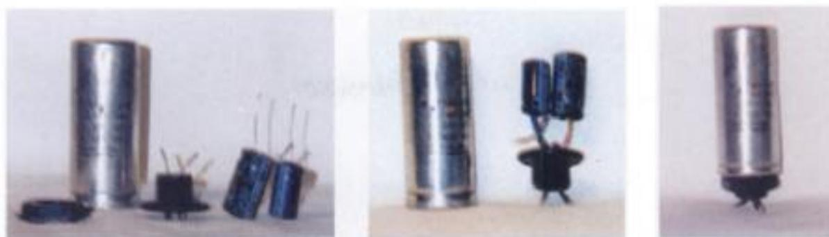
*Proceso de reposición de dos condensadores en la carcasa original.*
