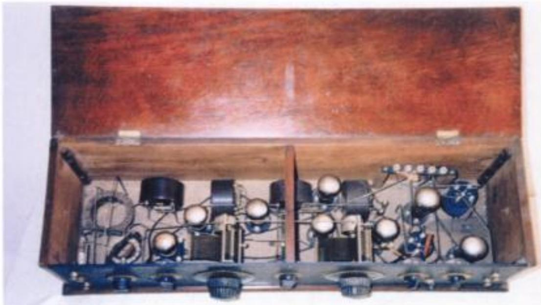
*Vista interior de un modulodino de baterías construido en 1930-31.*
